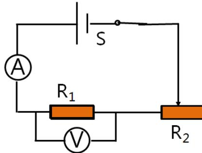
**例 2**、如图，当滑片 P 向左移动时，A 表和 V 表将如何变化。
