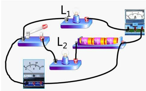
**例 2**、如图所示，电源电压不变。闭合开关  $S$  后，灯  $L_1$ 、 $L_2$  都发光，一段时间后，其中的一盏灯突然变亮，而电压表  $V_1$  的示数变小，电压表  $V_2$  的示数变大，则产生这一现象的原因是 ( )
