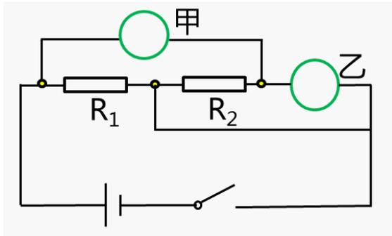
**例 2**、下图中，电路连接无误，闭合开关，电表均有示数，请判定甲、乙是电流表还是电压表。
