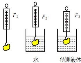
**例 2**、现有水、量筒、小木块（能放入量筒中），待测液体，小木块的密度小于待测液体的密度。只用这些器材测定未知液体的密度。
