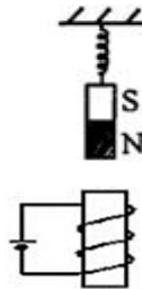
**例 3**、小磁针静止时 N 极指向如图所示，请画出通电螺线管的绕线情况
