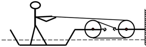
**例 3**、如图所示，木块体积为  $200\text{cm}^3$ ，人通过绳子拉住木块，使它恰能没入水中，若  $\rho_{\text{木}}=0.6 \times 10^3\text{kg/m}^3$ ，绳与轮之间摩擦、水的阻力不计，当匀速将木块拉入水面下 5m 深处时，求：拉力 F 所做的功？（ $g=10\text{N/kg}$ ）
